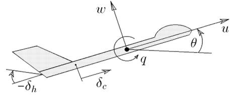
Fig. 1. Aircraft longitudinal motion model.
